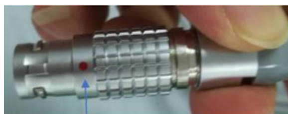
Czerwone oznaczenie w na wtyczce blokującej od rękojści lub przycisku nożnego
